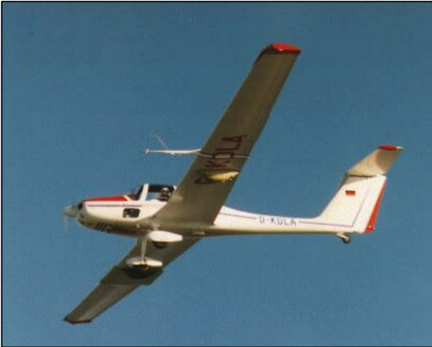
BILD 1. Das Messflugzeug D-KDLA vom Typ G109b des Fachgebietes Strömungslehre und Aerodynamik im Flug.
