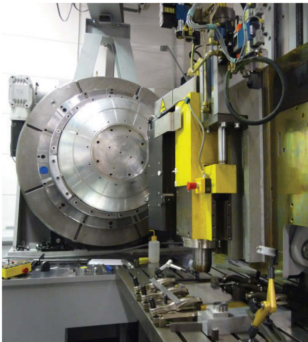
BILD 3. ESAB-Superstir-Anlage mit MT-Aerospace-Spannvorrichtung für die Polnahtschweißung
