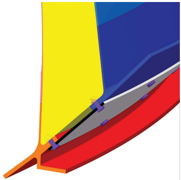
Bild 7. Common Bulkhead mit Schaumisolation (gelb) und Schürze zwischen den Ringen
