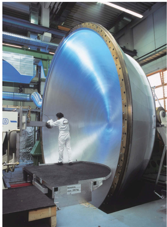
BILD 2. Drücken der rührreibgeschweißten Ronde
