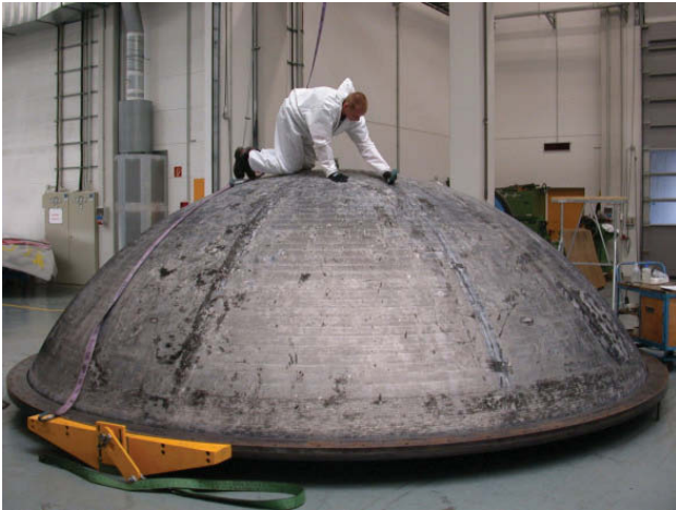
BILD 5. ARES I-Dom aus AA 2195 nach Wärmebehandlung
