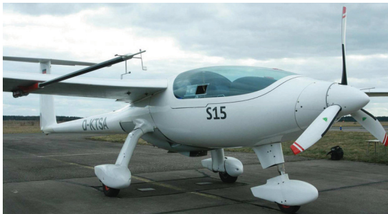
BILD 5: S15 (Prototyp der S6 im Projekt LAPAZ) ausgerüstet mit dem Kohlefaserrohr
