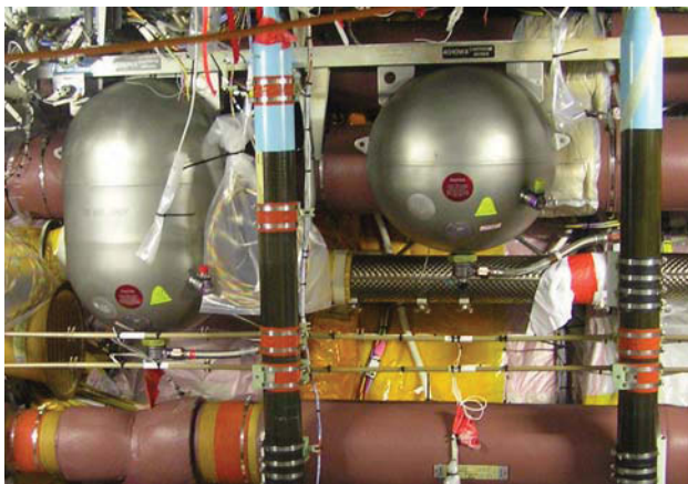
BILD 6. Brandunterdrückungsanlage für den Frachtraum
