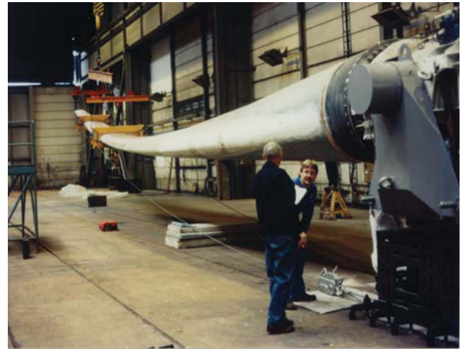
BILD 14. Verformung des Rotorblattes der Windenergieanlage MON 50 durch Biegebelastung
