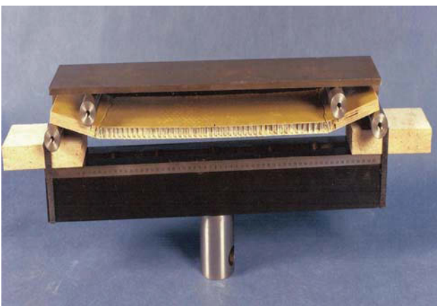
BILD 8. Gebrochene Sandwich-Langbiegeprobe mit Versuchsvorrichtung
