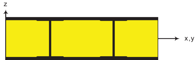
BILD 3. Prinzipskizze einer Sandwichplatte mit integrierten Profilen als Längsversteifung
