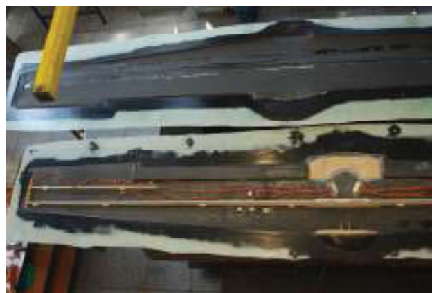
BILD 11. Flügelhälften kurz vorm Schließen
