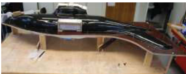
BILD 10. Positive Rumpfform in Hilfsvorrichtung
