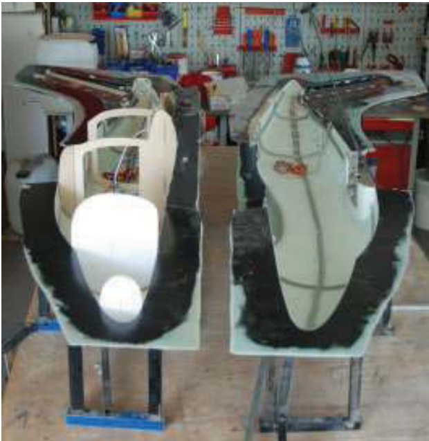
BILD 4. Rumpfhälften mit Einbauten
