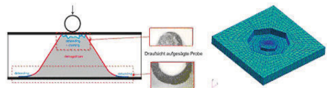
BILD 24. Schadensbild mit einem konischen Bruch (kritischer Fall) und dessen FE-Modellierung
