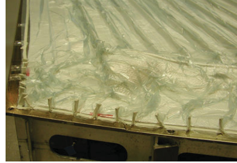
BILD 4. Aufwendige Fertigungsvorbereitung für eine stringerversteifte monolithische CFK-Schale
