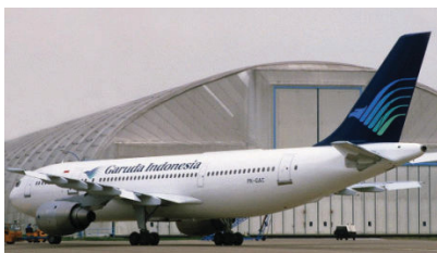
BILD 6. A310 mit dem weltweit ersten CFK-SLW und dem 2-Mann-Cockpit
