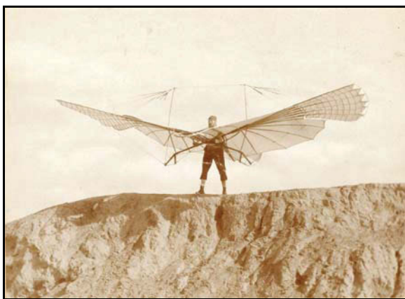
BILD 1. Erster Biege-/Torsionsantrieb zur subsidiären Schuberzeugung. Kleiner Schlagflügelapparat von O. Lilienthal 1894.
