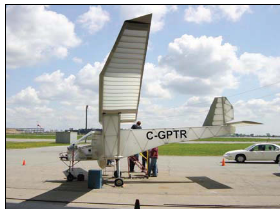
BILD 2. Bemanntes Flugzeug mit Biege-/Torsionsantrieb (J.D. DeLaurier, University of Toronto). Historischer Erstflug am 8. Juli 2006.
