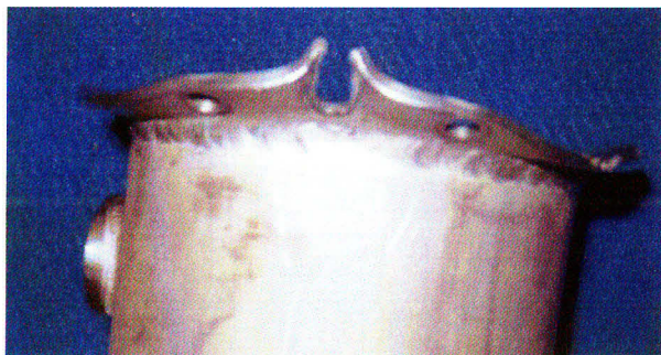
BILD 9. Der ausgerissene obere Flansch der HYDRA
