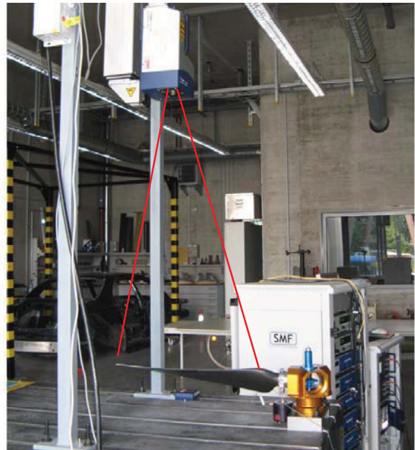
BILD 12. Bestimmung der Eigenmoden mittels Laser-Scanning-Verfahren
