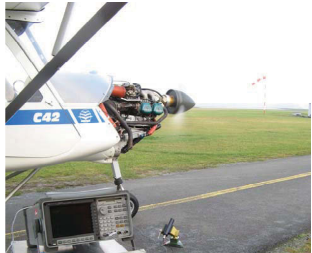
BILD 14. Aufnahme der Beschleunigungen am Getriebeausgang für verschiedene Motordrehzahlen
