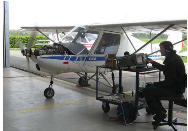
BILD 17. Aufnahme der Verzerrungen mittels DMS und Telemetriesystems während des Betriebes bei unterschiedlichen Drehzahlen und Winkelstellungen
