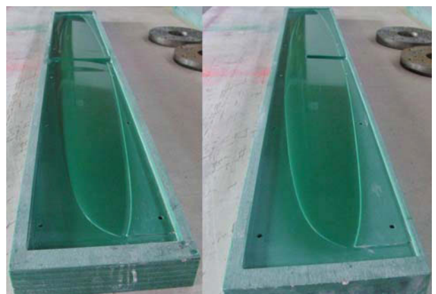
Bild 9: Gefräste und polierte Flügelformen.
