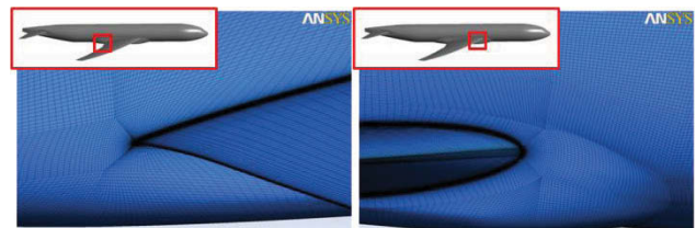
BILD 2. Oberflächengitter im Bereich Flügelhinterkante (links) und Flügelvorderkante (rechts)
