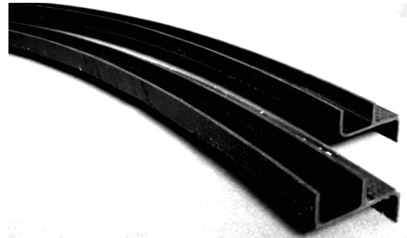
Abb. 6: Gefertigte Versuchsbauteile des CFK-Spantes mit LCF-Querschnitt
