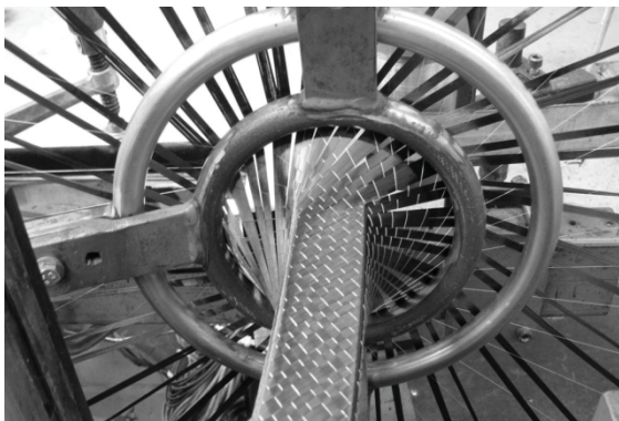
Abb. 3: Flecht-Wickel-Verfahren für Spantpreforms
