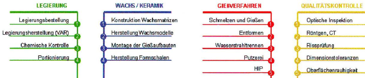
BILD 4: Schematische Darstellung des Feingussverfahrens. Jeder einzelne Schritt muss identifiziert, beschrieben und dokumentiert werden, so dass die gesamte Prozesskette zu einer reproduzierbaren und kosteneffizienten Produktionstechnologie führen kann.
