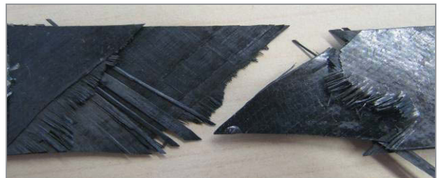
BILD 12. Bruchbild Vergleichsmaterial ohne angepasste Thermoplastschicht
