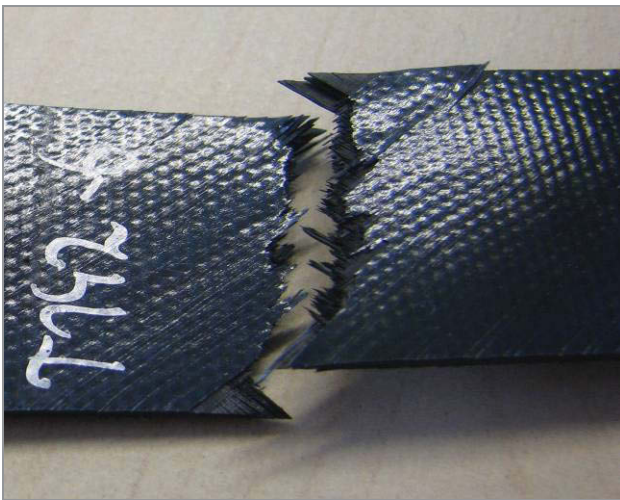
BILD 10. Zerstörter \pm 45^\circ Prüfkörper in Presstechnik
