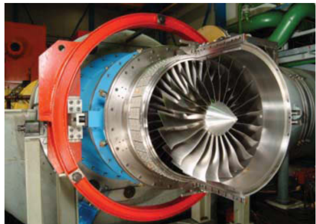
BILD 1: UHBR-Fan im M2VP Prüfstand [1]
