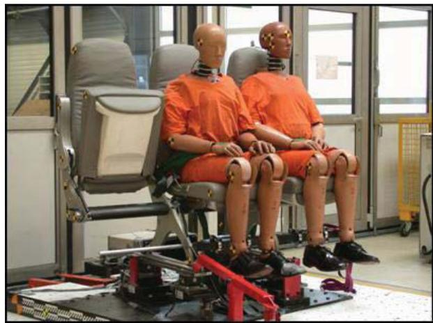
BILD 6. Sitzanordnung mit Dummys für 16g-Test
