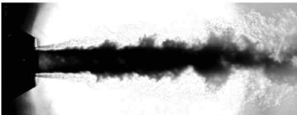
BILD 4. Einspritzung von LN_2/He bei p_c = 60\text{ bar} , überkritisch, Mayer & Smith [3]
