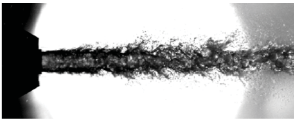
BILD 3. Einspritzung von LN_2/He bei p_c = 10\text{ bar} , unterkritisch, Mayer & Smith [3]
