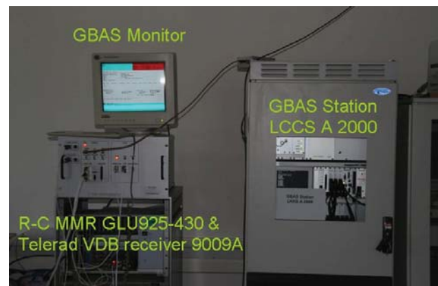
BILD 8. Experimentelle GBAS-Bodenstation am Institut für Flugführung der TU Braunschweig
