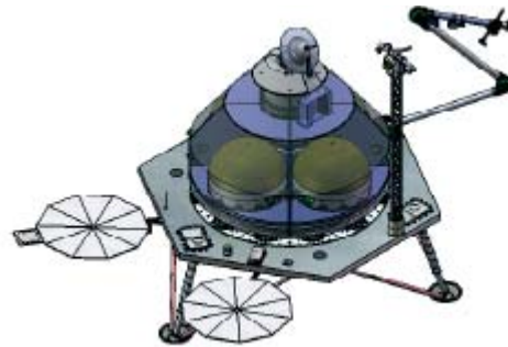
BILD 10. Draufsicht: MAV inklusive Landemodul
