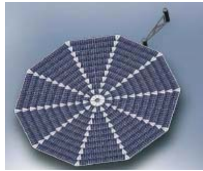
BILD 7. Solarzellenanordnung des Landemoduls
