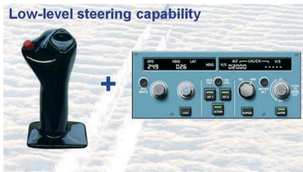
BILD 5. Flightstick und FCU Airbus als Beispiel der Mindest-Funktionalität der Flugwegbeeinflussung in der GCS
