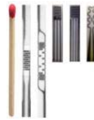
BILD 2. FIPEX-Sensoren im Größenvergleich (links: Sensoren für FIPEXonISS mit einem Streichholz; rechts: Sensoren für SOMP)
