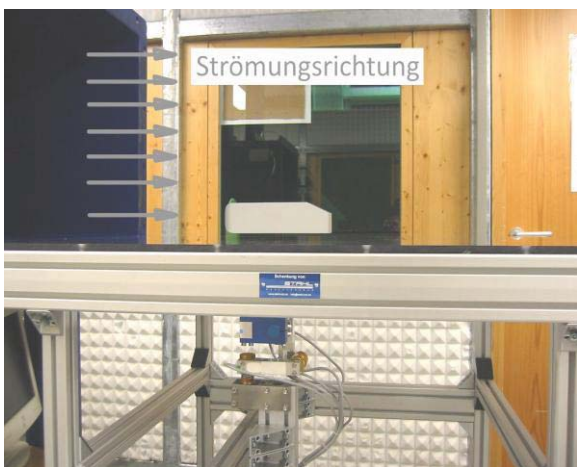
BILD 26. Versuchsaufbau in der Messkabine des RWT (3/4-offenen Messstrecke, Ahmed-Körper über Haltestiel mit der 6-Komponenten-Waage (unterhalb der Fahrbahn) verbunden)
