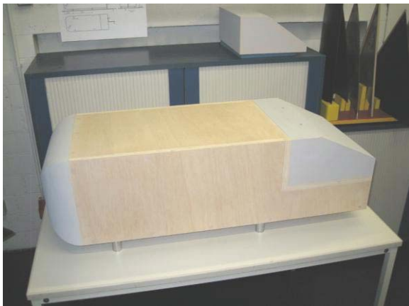
BILD 25. 1:5 Ahmed-Körper am Windkanal der Hochschule der Bundeswehr München [3]
