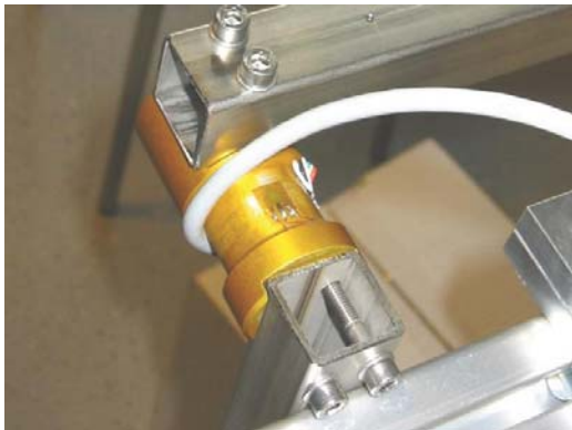
BILD 16. Befestigung Drehmomentstab M_y bzw. M_x über Verschraubung (Darstellung im Einzeltest)
