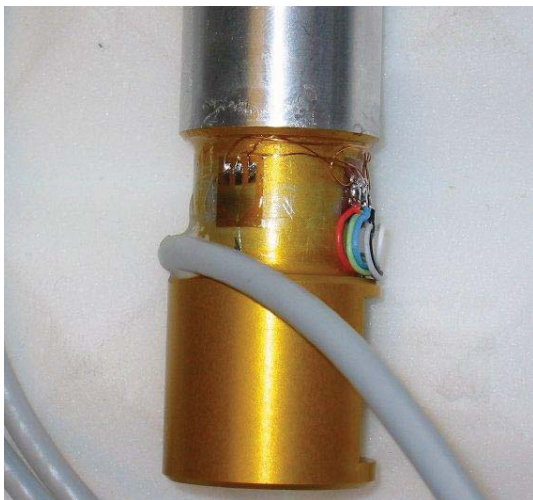
BILD 4. Verbindungselement mit DMS zur Drehmomentmessung (Z-Achse)
