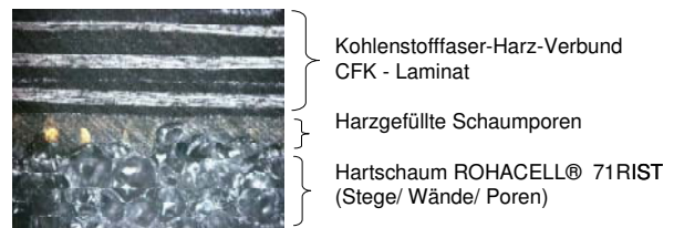
BILD 5. Interface CFK-Hartschaum-Sandwich
