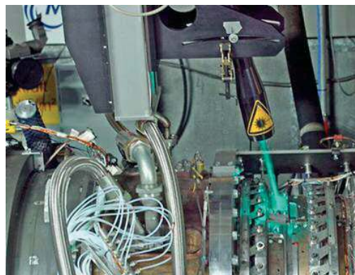
BILD 27. Versuchsaufbau zur Lasermessung im Bereich der Frontstufe
