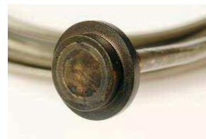
BILD 30. Neu entwickelte Coulombsonde ( \varnothing = 8 \text{ mm} ) nach dem Validierungsversuch
