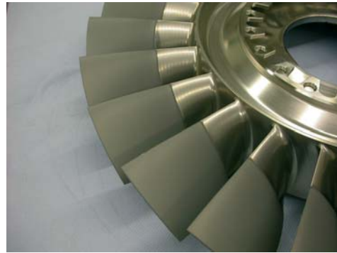
BILD 20. Experimental-Verdichterbisk mit Hochtemperatur-Multilayer-Schutzschicht
