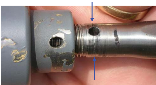
BILD 17. Gebrochener Steuerhebelarm im Bereich des Splintloches
