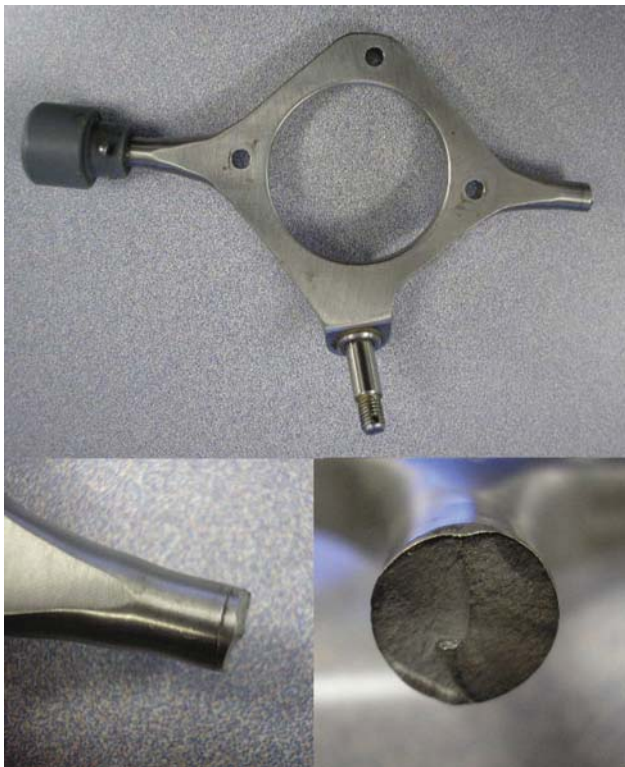
BILD 10. Bruch der Befestigung des Ausgleichsgewichtes
