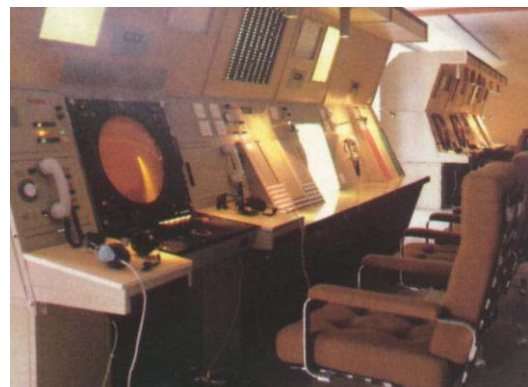
BILD 16 – Radar-Simulator im neuen Fliegertrainingszentrum [6]
