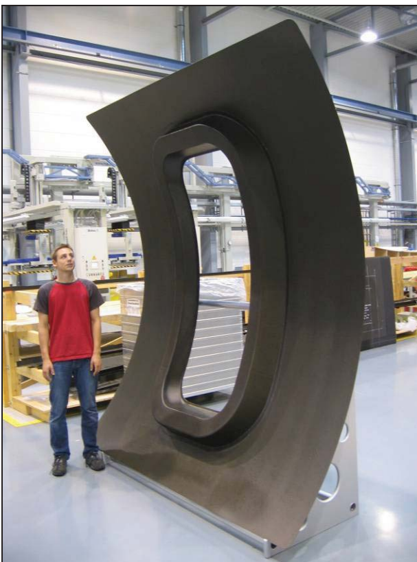
BILD 2. Türrahmendemonstrator des DLR Braunschweig
