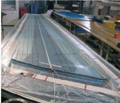
BILD 1. LRI-Versuch an einer sandwichverstärkten CFK-Schale im A320-Masstab - Der dunkle Bereich links und rechts des Zentralangusses zeigt den Verlauf der Fließfront
