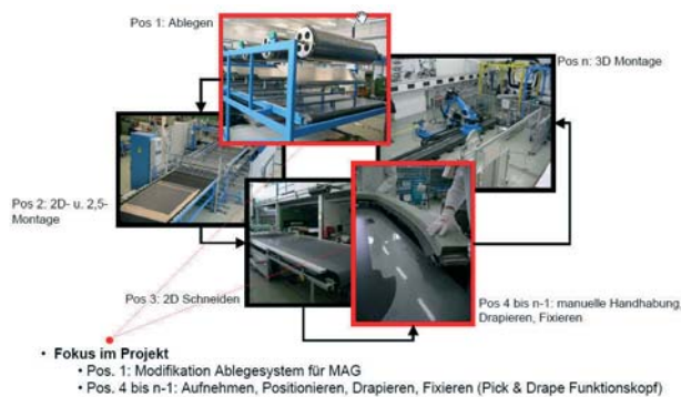
BILD 9. Prozesskette zur Fertigung von Helikopterspanten
