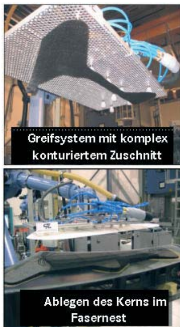
BILD 2. Oben: Greifsystem zum Ablegen der komplex konturierten Zuschnitte - Unten: Ablage des Schaumkerns auf bereits positionsgenau drapierten Faserlagen
