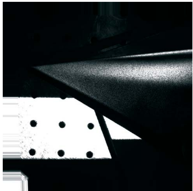
BILD 5. Von der Kamera erfasstes Messbild der Außenspiegelhalterung inklusive der zufälligen projizierten Punktemuster.
