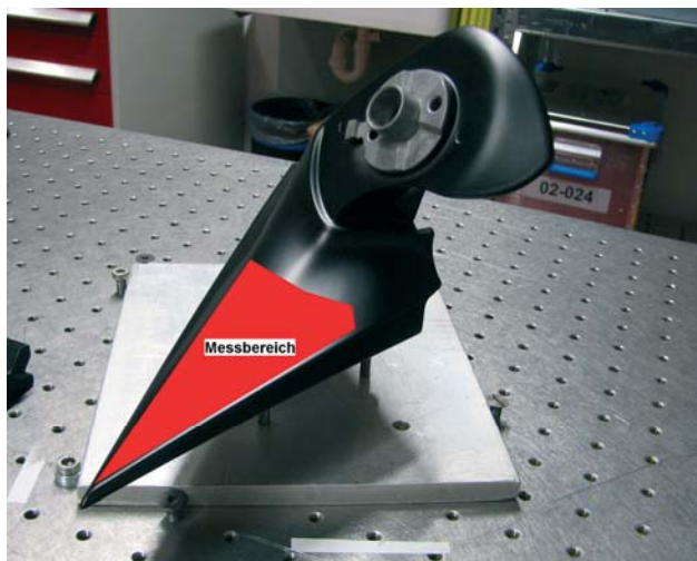
BILD 4. Farblich markierter Messbereich an einer zu untersuchenden Außenspiegelhalterung.
