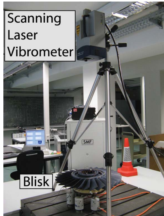
BILD 6. Experimenteller Aufbau zur Messung von Umlaufwellen
