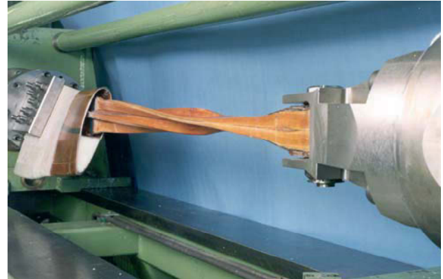
BILD 9. Der Bereich des „Flexbeams“ und der Steuertüte des EC135-Rotorblattes mit den wesentlichen Beanspruchungsarten
