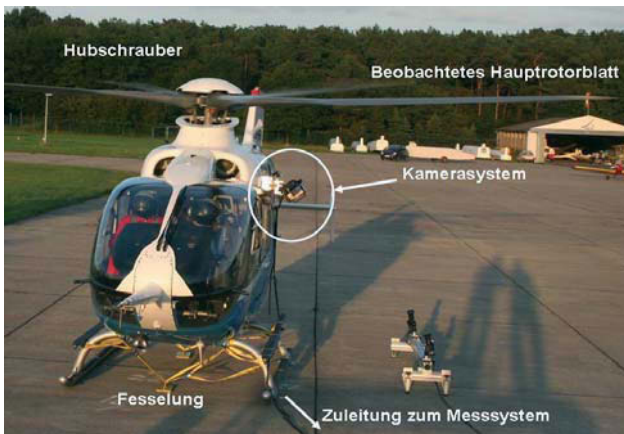
BILD 8: Bodentest zur IPCT-Messung der Rotordeformation am Hubschrauber
