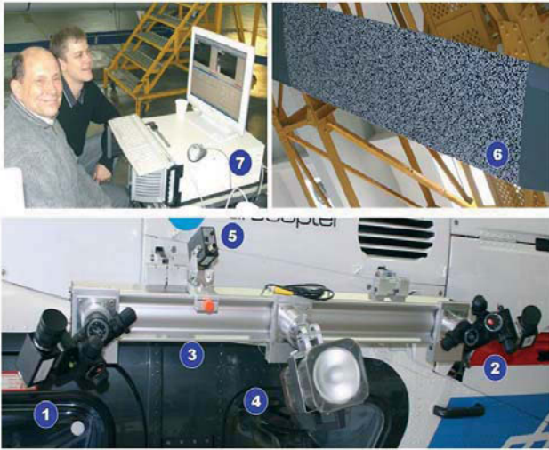
BILD 1: Messequipment zur Durchführung einer IPCT – Messung (Beispiel: Hubschrauberrotor; 1 – Kamera 1; 2 – Kamera 2; 3 – Grundträger; 4 – Blitzlampe; 5 – Reflexlichtschranke; 6 – unregelmäßiges Punktmuster auf Rotorblatt; 7 – Videostroboskop)
