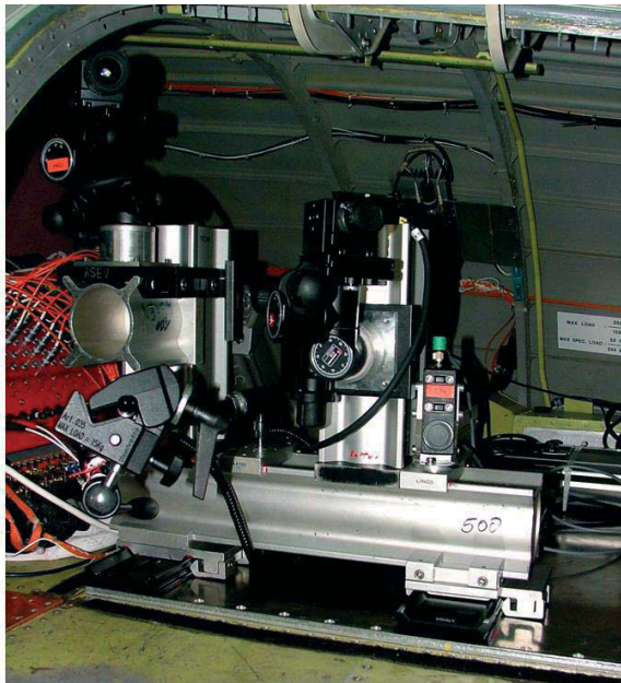
BILD 6: Kamerabefestigung in der Piaggio P 180
