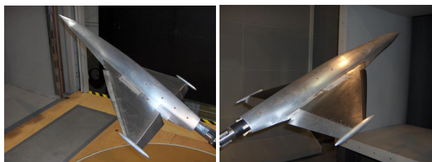
BILD 7. konventioneller (links) und formvariabler (rechts) Klappenausschlag am Modell
