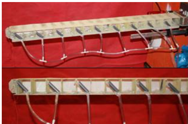
BILD 22. Halboffenes Kastenprofil mit Knickstäben (Einzelstäbe im Rohr)
