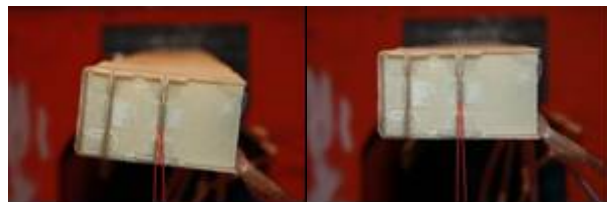
BILD 23. Verwindung des halboffenen Kastens unter Last, rechts mit durch Luftdruck gestützten Stäben
