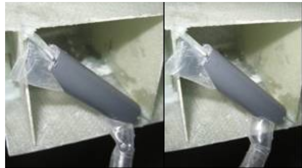
BILD 17. Beispiele für einzelne Knickstäbe im Rohr, links geknickt, rechts mit Luftdruck stabilisiert
