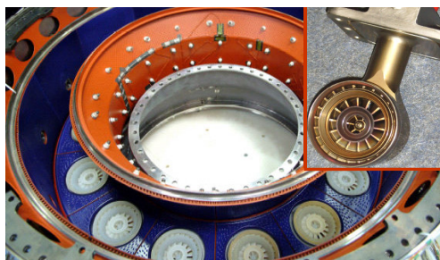
Abb. 19 Vollringbrennkammer mit Prototypenbrennern
