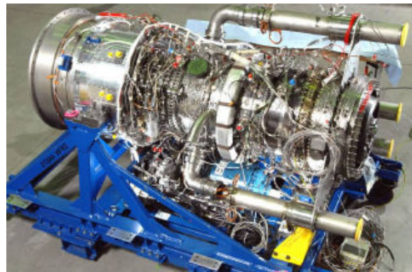
Abb. 24 E3E Kerntriebwerk (Core3/2) mit Instrumentierung
