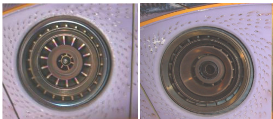
Abb. 23 Zustand der Magerbrenner nach den Hochdruckversuchen im Vollringprüfstand.
