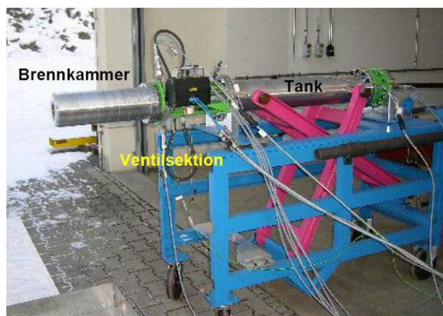
BILD 13. Der TD-T mit 2,7 kN Nennschub und Druckgasförderung
