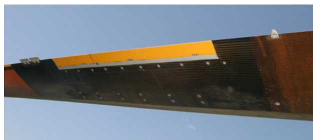
BILD 11. Integration der Blatt-Hinterkantenklappe am Eurocopter Versuchshubschrauber
