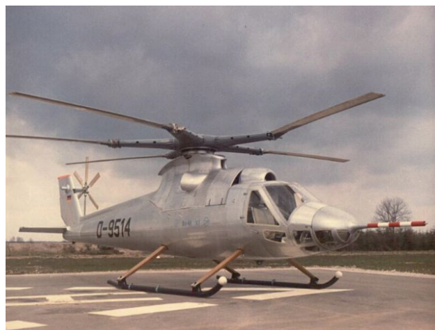
BILD 5. Eurocopter (Bölkow) BO 46 mit schwenkgesteuertem Hauptrotor
