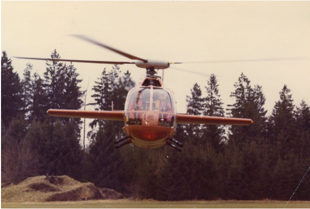
BILD 2. Eurocopter (MBB) BO 105 „Hoch-Geschwindigkeits-Hubschrauber“ (HGH)
