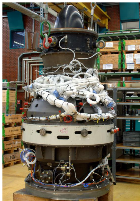
BILD 8. Rigaufbau für den Höhenprüfstand Stuttgart
