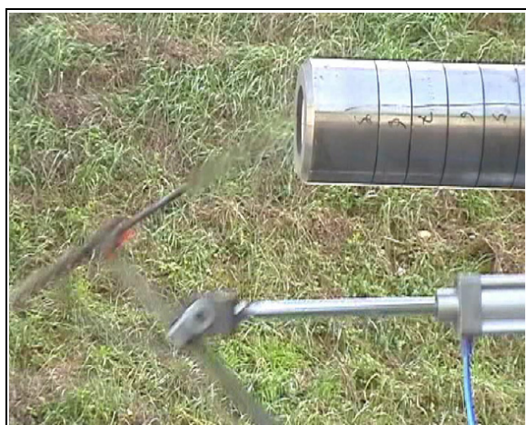
Abb 3.5-1: Anzündversuch mit dem TD-T (2,7 kN Nennschub) mittels Gaslanze
