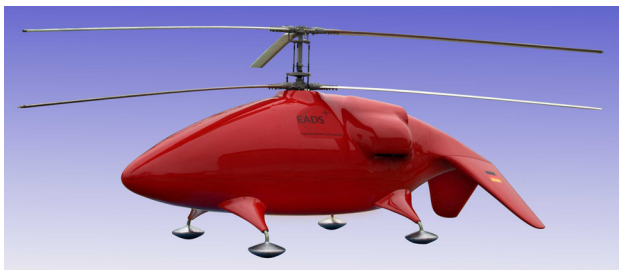
BILD 1. Koaxial-Hubschrauber-UAV SHARC [EADS]
