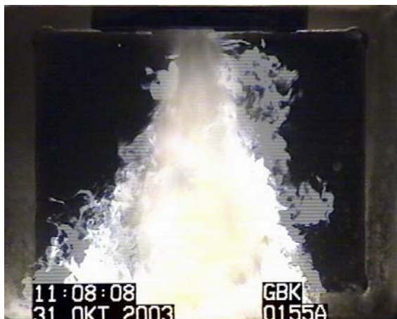
BILD 9. Brennversuch mit einem gelförmigen Brennstoff
