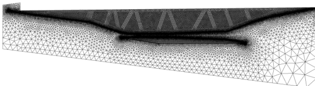
BILD 5: Rechennetze für Struktur und Fluid
