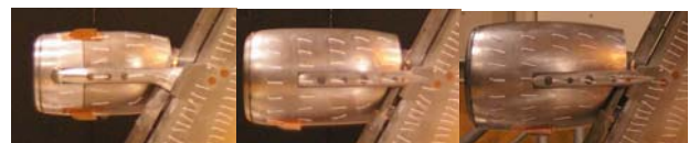
BILD 3. Die drei verwendeten Gondeln: Referenz, VHBR und UHBR (von links) mit Transitionsstreifen
