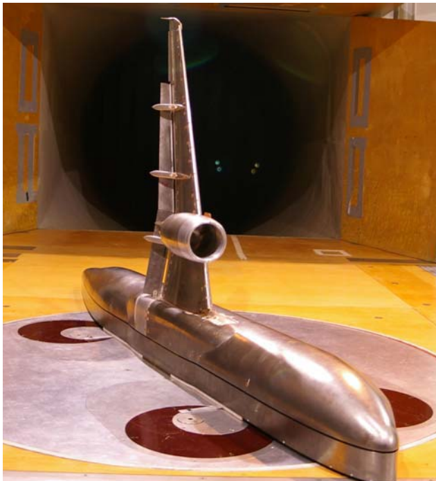
BILD 2. Windkanalmodell einer typischen Transportflugzeugkonfiguration
