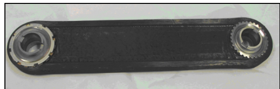
Bild 13: CFK Rear Link mit integrierten Lagern
