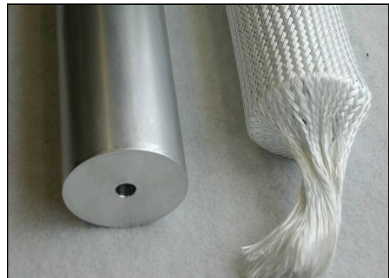
Bild 9: Aluminium Kerne mit GFK Geflecht
