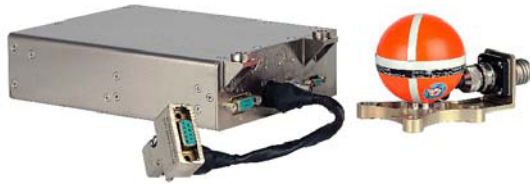
BILD 3. Miniatur FDR-System: Mini FDR DAU (links), Smart FDR (rechts)
