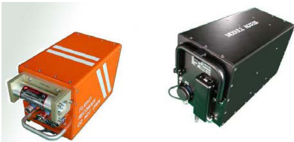
BILD 5. VFDRS 'Fixed Installed' Konfiguration: CSMU (links), DAU (rechts)
