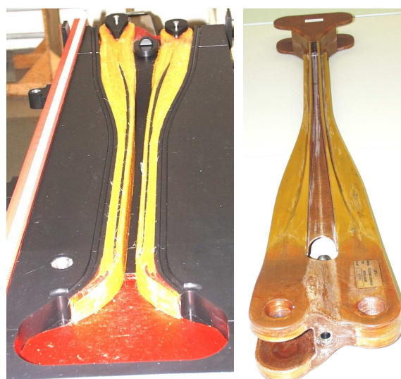
BILD 6 Flexelement während der Fertigung und nach der Entformung
