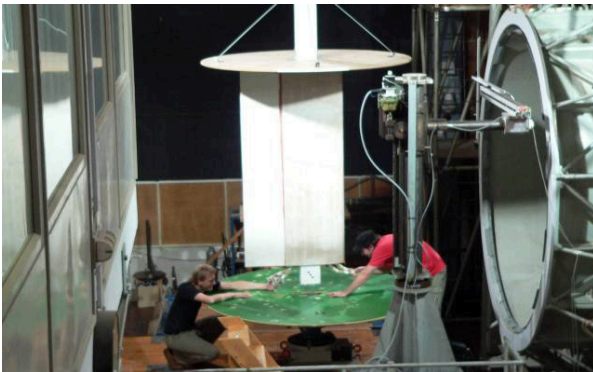
BILD A1. Einsetzen des Modells in die Messstrecke
